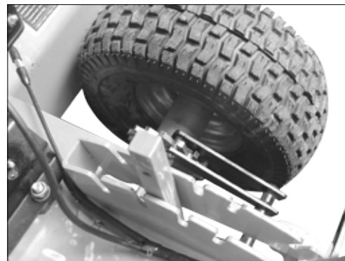
Geblocktes Laufrad mit der Fallklinke bei Frästiefeneinstellungen von 1 - 3 (MIN. - MAX.).
